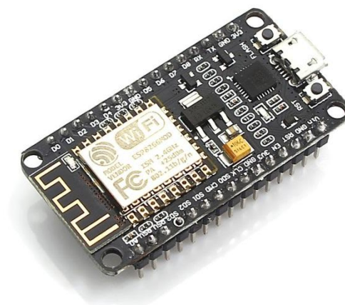
Gambar 1.3 Modul nodeMCU
